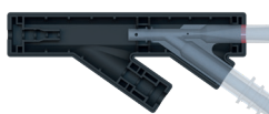
Afbeelding 2 (B): Een tekening van de handgreep van de katheter van 2,0 mm. De 2 poorten aan de rechterkant: de bovenste poort voor de spoeling met zoutoplossing voor de geleidedraadlumen en de onderste poort voor de aspiratieslang.
