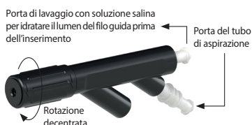
Figura 3 (b): Vista ingrandita dell'impugnatura del catetere da 2,35 mm. Sul lato prossimale del dispositivo sono presenti due porte: la porta superiore è utilizzata per il lavaggio con soluzione fisiologica per idratare il lume del filo guida prima dell'inserimento di quest'ultimo, mentre la porta inferiore è utilizzata per collegare il dispositivo al tubo di aspirazione.
